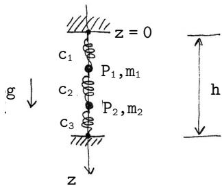
Si consideri il sistema di figura, composto da due punti pesanti,  $P_1$  di massa  $m_1$ , e  $P_2$  di massa  $m_2$ , liberi di scorrere lungo una guida verticale e collegati da tre molle ideali e con lunghezza a riposo 0 come nel disegno.
