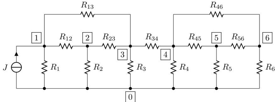
Detta  $x_k$  la tensione del nodo  $\boxed{k}$  rispetto al nodo  $\boxed{0}$  ed  $x$  la colonna di componenti  $x_1, \dots, x_6$ , la legge di Kirchhoff delle correnti (somma delle correnti uscenti dal nodo = zero) per i nodi  $1, \dots, 6$  rispettivamente, assume la forma di un sistema di equazioni lineari nell'incognita  $x$ :
