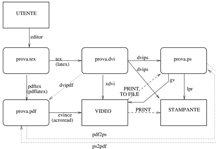
Figura 1: Le fasi di lavorazione di un file  $\text{T}_{\text{E}}\text{X}$ . Le frecce tratteggiate indicano comandi dell'interfaccia grafica. Le frecce puntinate indicano comandi che possono compromettere la qualità del documento.
